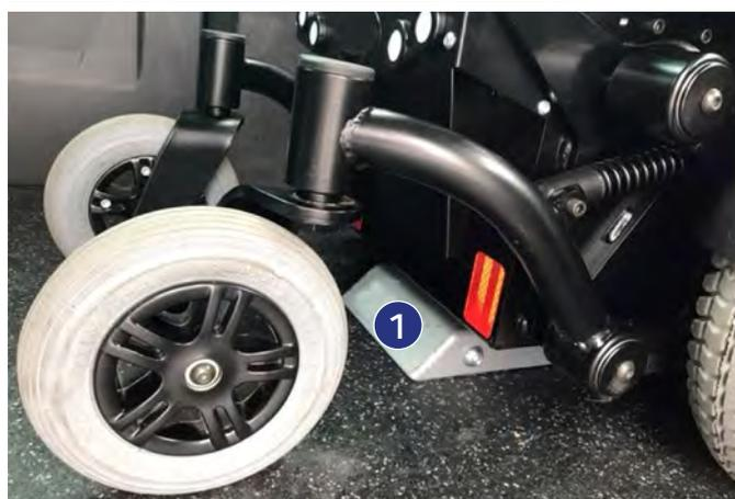
Figure 7 : ancrage automatique
