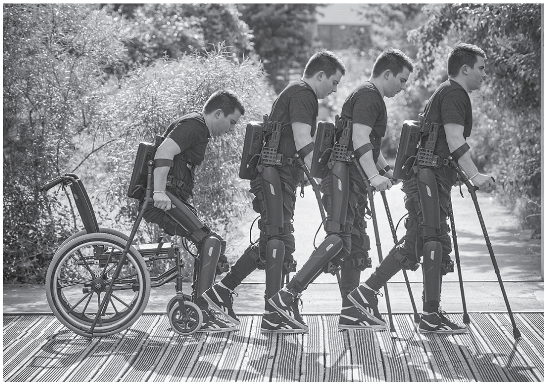
Exosquelette robotique conçu et commercialisé par la société israélienne Argo Medical Technologies permettant à une personne paraplégique de retrouver une mobilité.
